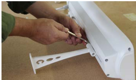
Inbus Schrauben mit Federring immer von der Kabelseite des Gerätes aus einfädeln
